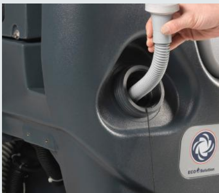
Standaard vulslang voor aansluiting op de kraan (aparte afvoerslang voor legen van de vuilwatertank, terwijl gelijktijdig gevuld kan worden)
